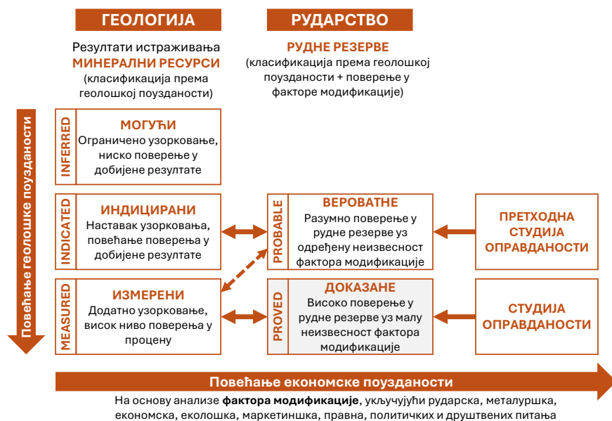
Слика 2.1. Општи однос између резултата истраживања, минералних ресурса и минералних резерви
